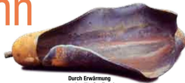
Durch Erwärmung zerknallte Gasflasche.
