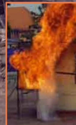
So eine Fettexplosion entsteht, wenn brennendes flüssiges Fett oder Öl mit Wasser gelöscht werden soll.
